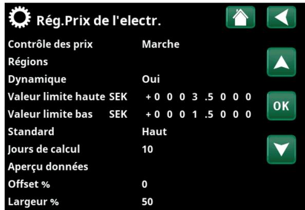
Menu : « Installateur/Réglages/Communication/Prix de l'electr. » où « Installateur/Définir/Communication/myUplink:Oui » est sélectionné.
