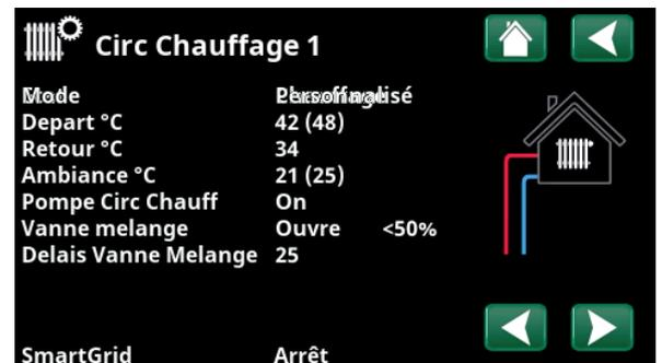
Le menu affiche les données de fonctionnement détaillées du circuit de chauffage sélectionné. Cliquez sur les flèches ou faites glisser pour afficher les circuits de chauffage définis.
