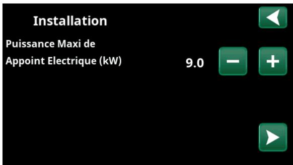
5. Sélectionnez la puissance maximale de l'appoint électrique à l'aide des boutons «+» et «-». Confirmez avec la touche fléchée «droite». Pour plus d'informations sur les réglages, reportez-vous au chapitre «Installateur/Réglages/Appoint électrique».
