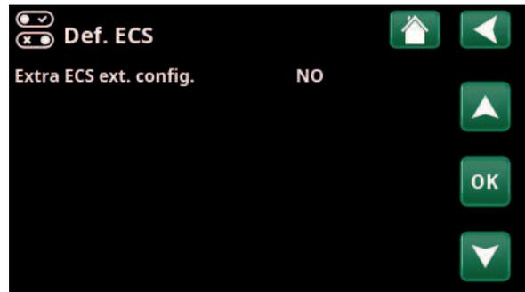
Menu : «Installateur/Définir/ECS» Dans la barre de menus «Extra ECS ext. config.», le mode normal est spécifié pour le signal de commande externe (« Normalement ouvert (NO)» ou «Normalement fermé (NF)»).
