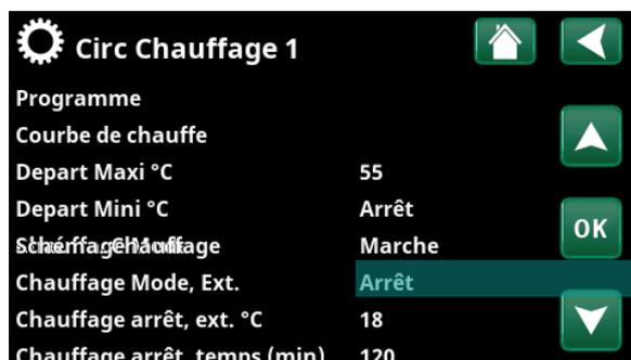
Menu : «Installateur/Réglages/Circ Chauffage/Circ Chauffage 1» Le mode de contrôle à distance «Arrêt» devient actif lorsque le bornier de connexion K24 se ferme.
