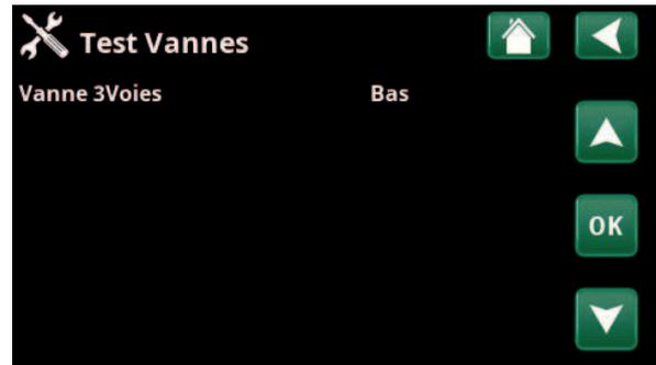
Menu : «Installateur/Service/Test Relais/Vannes ».
