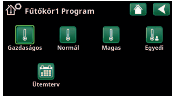
A „Fűtőkör1 Fűtés/hűtés / Fűtőkör1 Program” menü, ahol a „Gazdaságos” program van bekapcsolva.
