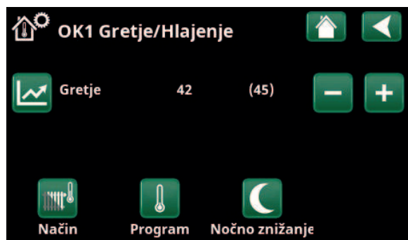
Meni »Instalater/Določí/Ogrevalni krog/Ogrevalni krog 1«. Ogrevani krog nima sobnih senzorjev. Nastavljena vrednost (temperatura primarnega pretoka znaša 45\text{ }^{\circ}\text{C} ) je prikazana v oklepaju, trenutna temperatura primarnega pretoka 42\text{ }^{\circ}\text{C} je prikazana levo od nastavljene vrednosti.
