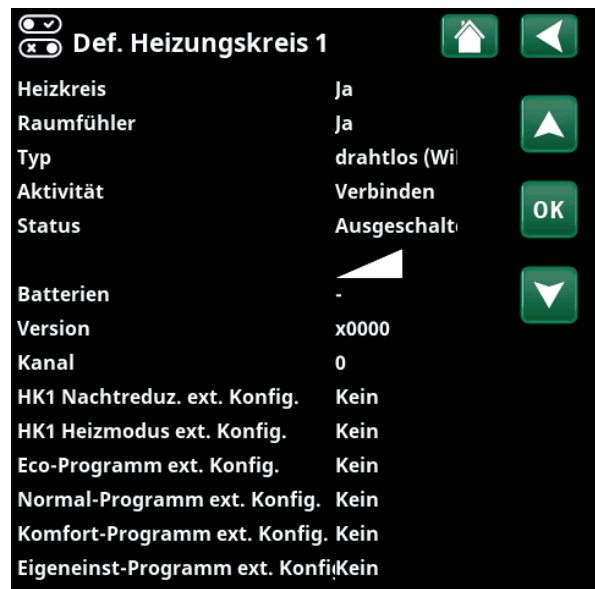
Menü: „Fachmann/Definieren/Heizkreis/Heizkreis 1“. Drahtloser Raumfühler ausgewählt.
