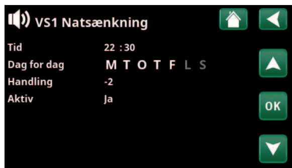
Indstilling af Natsenkning (-2 °C), hverdagsnætter.
