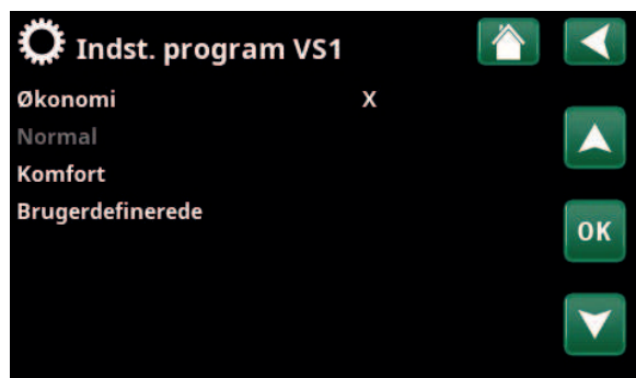
Menu "Avanceret/Indstillinger/Varmesystem/Varmesystem 1/ Program".
