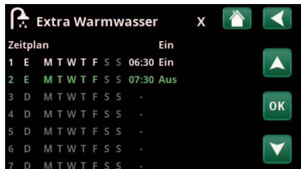
Die Funktion „Extra WW“ ist wochentags von 06:30 bis 07:30 aktiv. Klicken Sie auf das DHW-Symbol, um eine Vorschau unten zu sehen.
