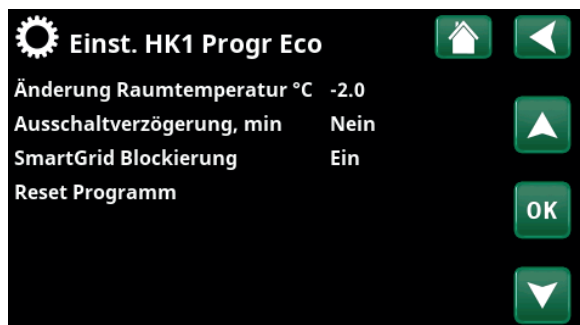
Menü „Fachmann/Einstellungen/Heizkreis/Heizkreis 1/Programm/Eco“.
