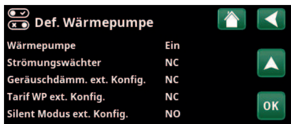
Menü: „Fachmann/Definieren/Wärmepumpe“. Für „Tarif WW ext. konfig“ wird Modus „Normal“ für das externe Steuersignal (standardmäßig offen (NO) / standardmäßig geschlossen (NC)) festgelegt.
