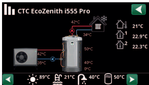
Hoofdmenupagina voor "Werkingsdata" met aangesloten lucht-water warmtepomp CTC EcoAir. Wanneer de pompen in werking zijn, roteren ook de pictogrammen van de pompen op het scherm.
