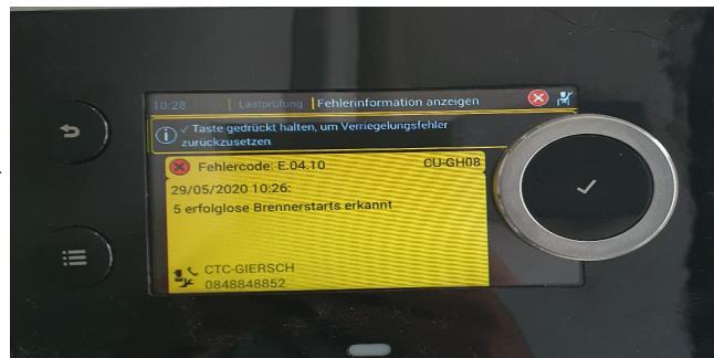
Comme décrit dans l'affichage, appuyez et maintenez la roue rotative avec la coche ✓ pour effacer l'appareil. L'appareil tente un redémarrage. Si la panne se reproduit, répétez la procédure 2 fois.
