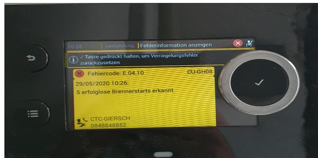
Wie im Display beschrieben Drehrad mit Häkchen ✓ gedrückt halten um das Gerät zu entstören. Gerät versucht einen Neustart. Bei erneuter Störung, Vorgang 2 mal wiederholen.
