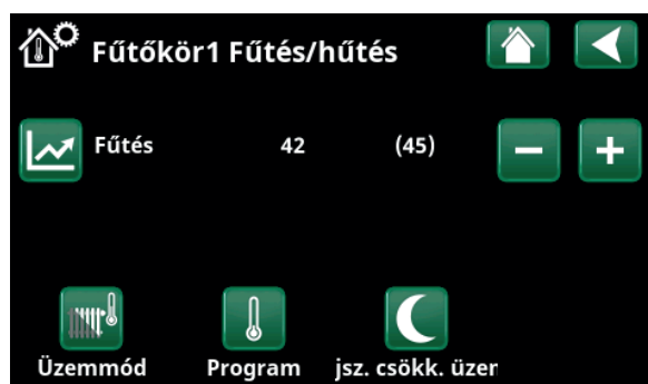
A „Telepítő/Ált. beállítások/Fűtési kör/1. fűtési kör” menü. A fűtési kör nem rendelkezik helyiségérzékelőkkel. A beállított érték (45 °C-os előremenő hőmérséklet) zárójelben van feltüntetve, a beállított értéktől balra az aktuális 42 °C-os előremenő hőmérséklet van feltüntetve.
