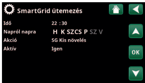
Menü: „Telepítő/Ált. beállítások/SmartGrid ütemezés”.
