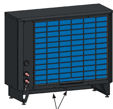
Kondensvannbeholder og kondensvannrør.
