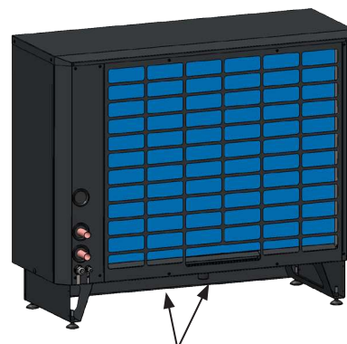
Kondenssivesialtaat ja kondenssivesiputket.
