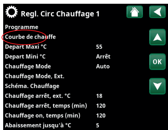
Partie du menu « Installateur/Réglages/Circ Chauffage/Circ Chauffage 1 ».
