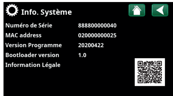
Menu : «Installeur/Info. Système» Pour accéder à ce menu, cliquez sur le bouton «i» en bas à droite de l'écran du menu «Installeur».
