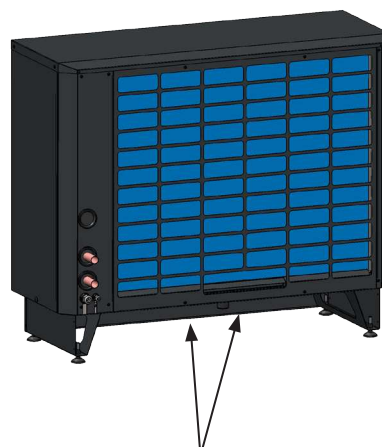
Bac à condensats et drain de condensats.
