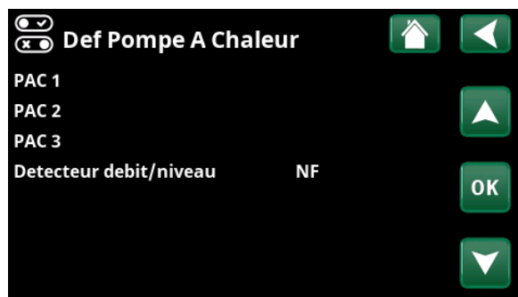
Exemple de système avec trois pompes à chaleur. Menu « Avancé/Définir système/Pompe à chaleur »
