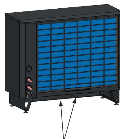
Kondensbakke og kondensvandafløb.
