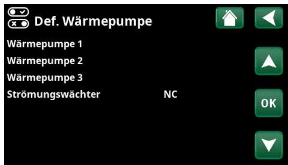
Beispiel eines Systems mit drei Wärmepumpen. Menü „Fachmann/Systemdefinition/Wärmepumpe“.
