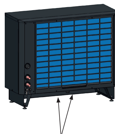
Condensaatbak en condensaatbaptap.
