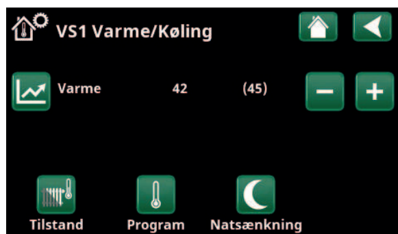
Menu "Installationsprogram/Definer/Varmekredsløb/Varmekredsløb 1". Varmekredsløbet har ingen rumfølere. Indstillingspunktet (fremløbstemperatur 45 °C) er vist i parentes, den aktuelle fremløbstemperatur 42 °C er vist til venstre for indstillingspunktet.
