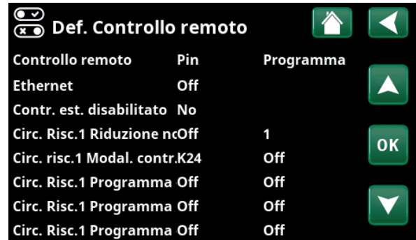
Parte del menù "Installatore/Definire/Controllo remoto". Qui vengono definiti "Input" e "Programma settimanale".
