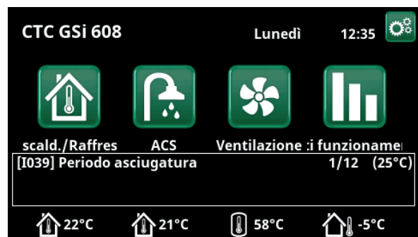
Esempio temperatura del periodo di asciugatura giorno 1 di 12 con setpoint attuale di 25 °C.
