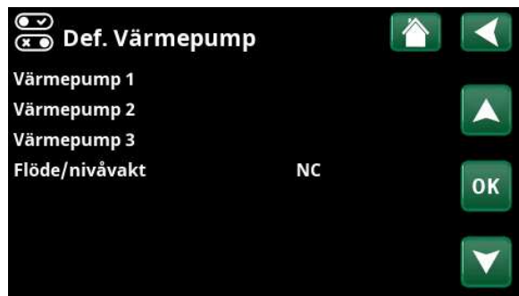
Exempel på system med tre värmepumpar. Meny "Avancerat/Definiera system/Värmepump"
