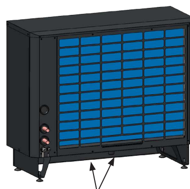
Kondenstråg och kondensvattenrör.
