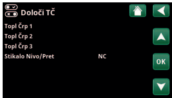
Primer sistema s tremi toplotnimi črpalkami. Meni "Napredno/Določi sistem/Topl Črp"
