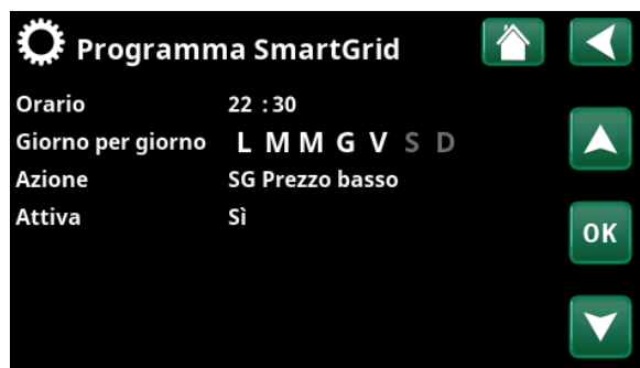
La funzione di SmartGrid "SmartGrid Prezzo basso" è pianificata per i giorni feriali nell'orario 22:30-06:00. Andare al menù selezionando "Programma SmartGrid" nel menù "Installatore/Impostazioni".
