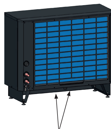
Kondensatsioonialus ja kondensatsioonivee äravool.
