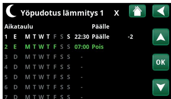
Aikataulussa on asetettu, että "Yöpudotus" on aktiivinen arkipäivisin klo 22:30 ja 7:00 välillä, paitsi perjantain ja lauantain sekä lauantain ja sunnuntain välisenä yönä (jolloin yöpudotusta ei tapahdu).
