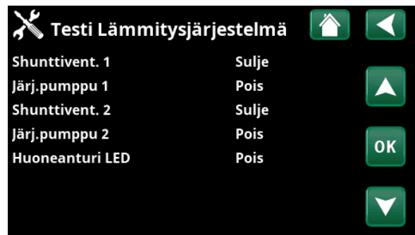
Valikko "Edistyneempi / Huolto / Testi / Lämmitysjärj.".
