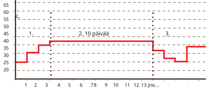
Esimerkki tilalle 2, jossa asetettu arvo toiminnolle "Lattiat toiminto lämp. °C": 37.
