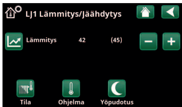
Valikko "Edistysellinen/Määrittele/Lämmityspiiri/Lämmityspiiri 1". Lämmityspiirissä ei ole huoneantureita. Asetuspiste (menoveden lämpötila 45 °C) näkyy suluissa, nykyinen menoveden lämpötila 42 °C näkyy asetuspisteen vasemmalla puolella.
