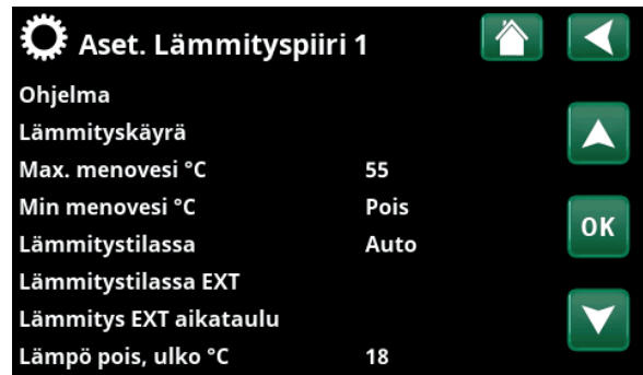
Valikko "Edistyneempi/Asetukset/Lämmityspiiri". Valikkorivillä "Lämmitystilassa EXT" asetetaan lämmityspiirin kauko-ohjaustila. Siirry aikataulu valikkoriviltä "Lämmitys EXT aikataulu".
