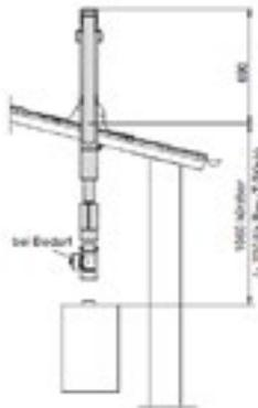
**Dachheizzentrale raumluft-unabhängig, DN 80/125
