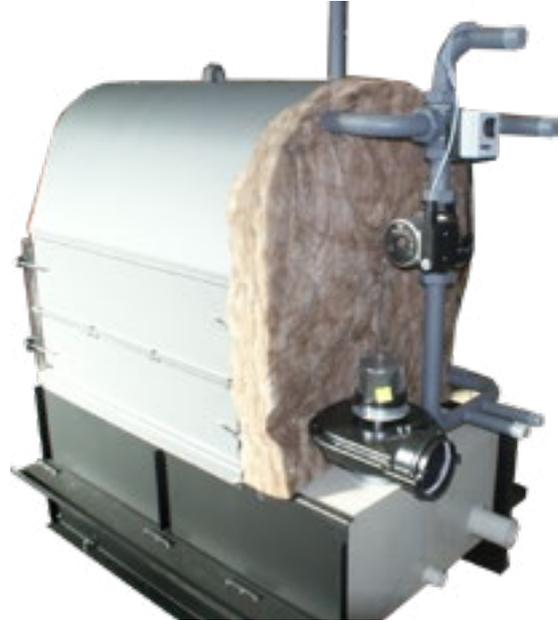
Vollkondensationsheizkessel mit garantierter Dauerkondensation für Öl-Betrieb. Innenkörper aus Stahl, patentierter Zuluft-/Abgas-Wärmetauscher aus Kunststoff, pulverbeschichtete Blechverkleidung, Farbe grün. Grundträger mit Tragegriffen und Stellfüssen. Mit Abgasgebläse und LAS-Anschlussadapter mit Messstutzen. VK Control 3 - Computergesteuerte Digitalregelung für EcoSwiss VK. In Kesselverkleidung integrierte Regelung für den Heizkessel
