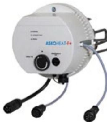
ASKOHEAT+ kommt mit dem Zweirichtungszähler zum Einsatz, um Überschussstrom aus der PV-Anlage in Form von Wärme im Warmwasserspeicher zu lagern. In unserem Lieferumfang erhalten Sie den ASKOHEAT+ 7-stufig in verschiedenen Leistungsklassen als 230V oder 400V Ausführung. Folgende Gerätevarianten stehen Ihnen zur Auswahl:
