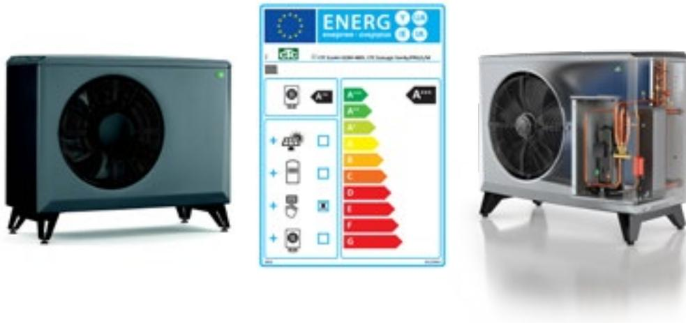
Die CTC EcoAir 600M ist eine modulierende Luft/Wasser Wärmepumpe für die Aussenaufstellung und für hohe Leistungen bei geringer Schalleistung ausgelegt. Die Wärmepumpe verfügt über eine integrierte Heissgas-Abtauung, das den Verdampfer zur Aufrechterhaltung einer hohen Leistungsfähigkeit eisfrei hält. Die Wärmepumpe kann entweder über den EcoLogic M/L angesteuert oder an den EcoZenith i255 L / EcoZenith i360 L / EcoZenith i555 Pro (nur
