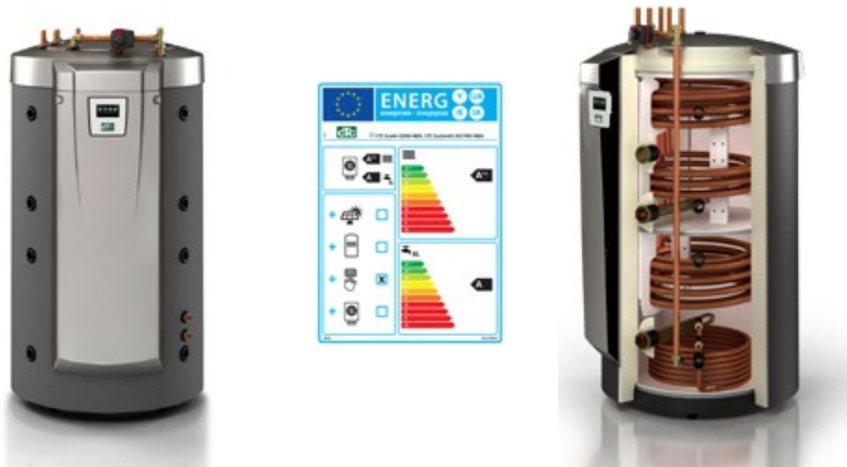
Der CTC EcoZenith i555 Pro ist ein Multi-Funktionsspeicher mit 540 Liter Speicher Inhalt. Warmwasseraufbereitung im Durchlaufprinzip mit zwei Rippenrohrwärmetauscher 2 x 18 m, ca. 13 m<sup>2</sup>. Solarwärmetauscher 10 m, ca. 2.8 m<sup>2</sup>. Schichtungsanlagen für schnelle Schichtung der Solarerträge. 4 Wege Heizkreismischer (für Heizleistung < 28 kW geeignet) Grössere Heizkreismischer als Option wählbar.
