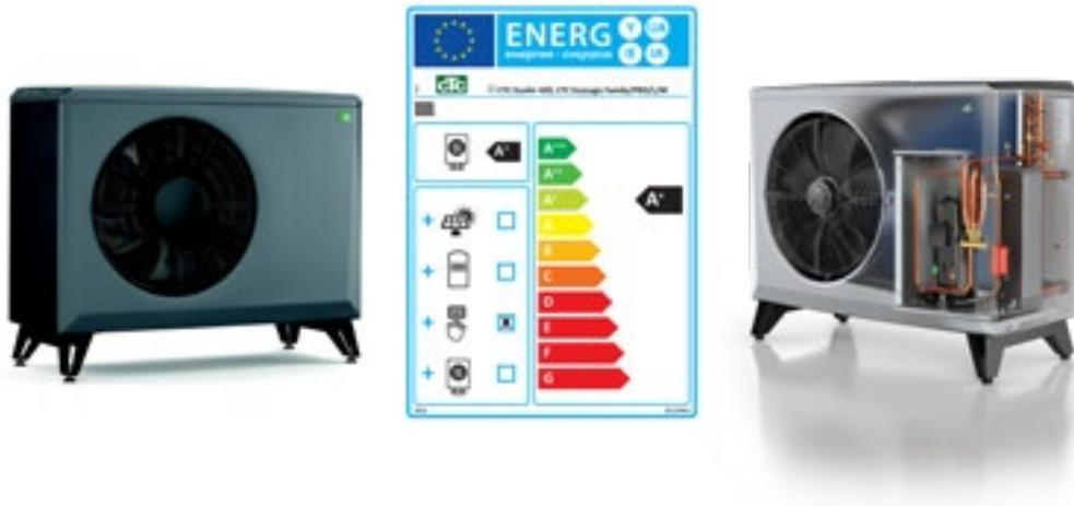
Die CTC EcoAir 400 ist eine Luft/Wasser Wärmepumpe für die Ausenaufstellung und für hohe Leistungen bei geringer Schalleistung ausgelegt. Die Wärmepumpe verfügt über eine integrierte Heissgas-Abtauung, das den Verdampfer zur Aufrechterhaltung einer hohen Leistungsfähigkeit eisfrei hält. Die Wärmepumpe kann entweder an den EcoZenith i255L/EcoZenith i555 Pro angeschlossen oder über
