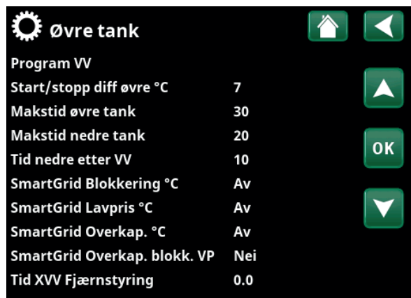
Meny «Avansert/Innstillinger/Inst. Øvre tank»
