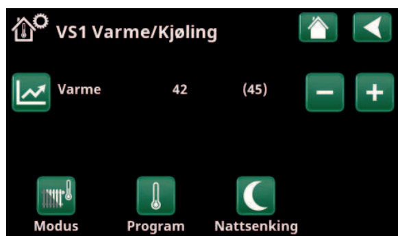
Menyen «Avansert/Definere/Varmesystem/Varmesystem 1». Varmesystemet har ingen romfølere. Børverdien vises i parentes (turledningstemperatur 45^{\circ}\text{C} ), aktuell turledningstemperatur 42^{\circ}\text{C} vises til venstre for børverdien.
