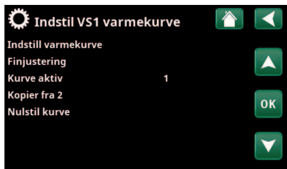
Menu "Avanceret/Indstillinger/Varmesystem/Varmesystem 1/ Varmekurve".
