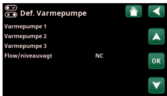
Menu: "Avanceret/Definere/Varmepumpe". Vælg en varmepumpe, og tryk på "OK" for at få adgang til indstillingerne.
