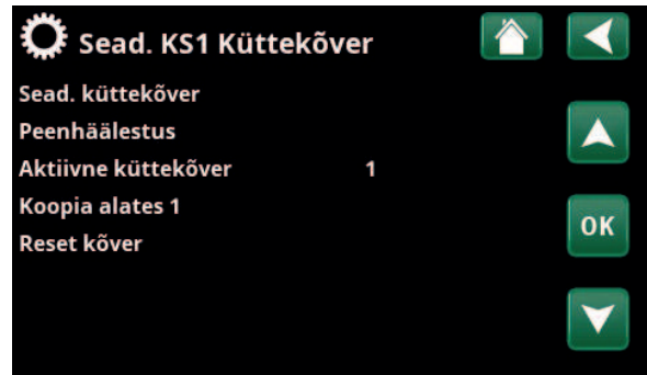
Menüü „Paigaldaja/Seadistus/Küttering/Küttering 1/Kütteköver“.
