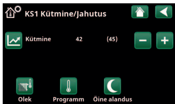
Menüü „Paigaldaja/Määratlemine/Küttering/Küttering 1“. Kütteringil ei ole ruumiandureid. Sulgudes on näidatud seadeväärtus (pealevoolutemperatuur 45\text{ }^{\circ}\text{C} ), seadeväärtus vasakul on näidatud praegune pealevoolutemperatuur 42\text{ }^{\circ}\text{C} .
