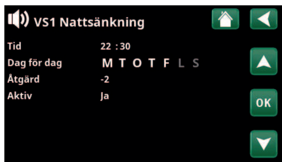
Inställning av nattsänkning (-2 °C), vardagsnätter.
