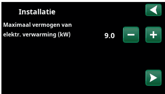
5. Selecteer het maximale vermogen van de elektr. weerstand met de knoppen "+" en "-". Bevestig met de "pijl naar rechts". Meer informatie over instellingen staat in het hoofdstuk "Installateur/Instellingen/Elektr. weerstand".
