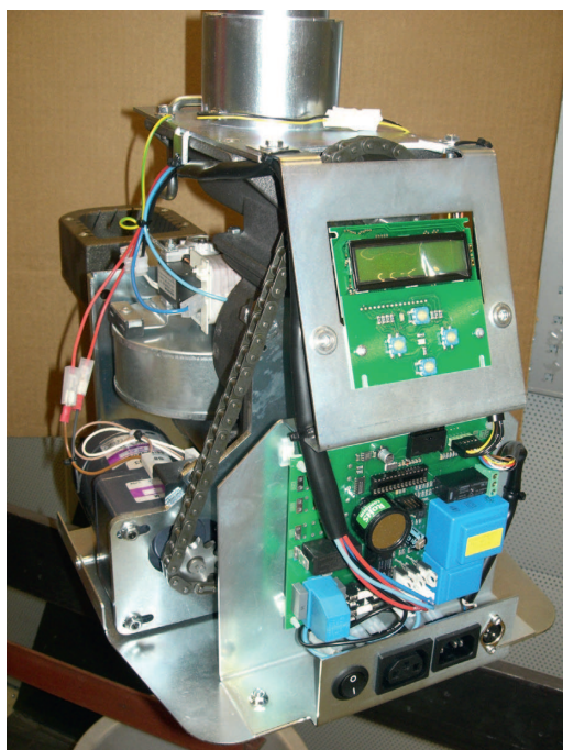
29. Montera styrpanel på plats och anslut alla kablar och kontakter på sin plats.
