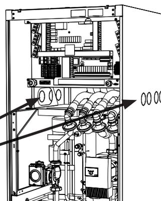
**!** Wenn ein Kollektor angeschlossen wird, muss die Durchführung mit der beiliegenden Randleiste isoliert werden, um zu verhindern, dass sie am Kabel scheuert.
