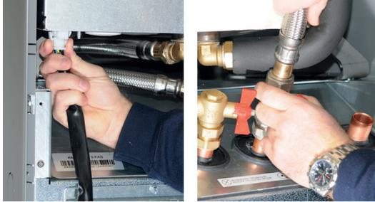
1. Trennen Sie den Stromversorgungsstecker und die Schläuche des Kältemoduls.
