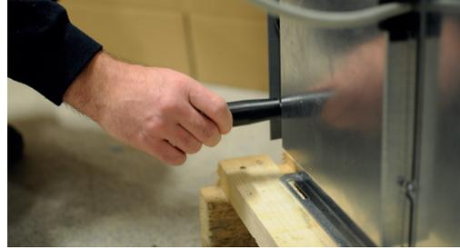
2. Befestigen Sie die beiden Traggriffe am Unterteil des Kältemoduls.
