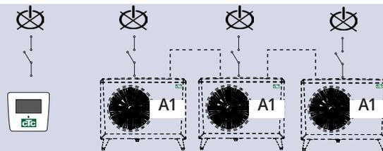
2. Alimentare il controllo (EcoLogic Pro o EcoZenith i550 Pro) e il CTC EcoPart 600M che sarà numerato come pompa di calore 2 (PDC2).
