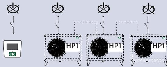
2. Alimentare il controllo (EcoLogic o EcoZenith i555 Pro) e il CTC EcoPart 600M che sarà numerato come pompa di calore 2 (PDC2).
