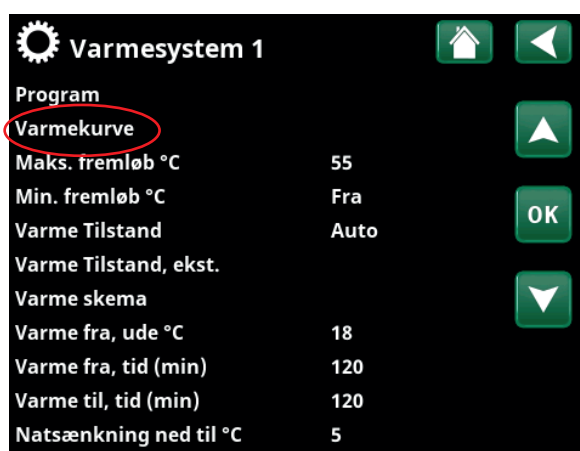
En del af menuen "Avanceret/Indstillinger/Varmesystem/Varmesystem 1".
