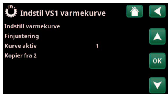
Menu: "Avanceret/Indstillinger/Varmesystem/Varmesystem 1"/Varmekurve". Kurve aktiv: #1.
