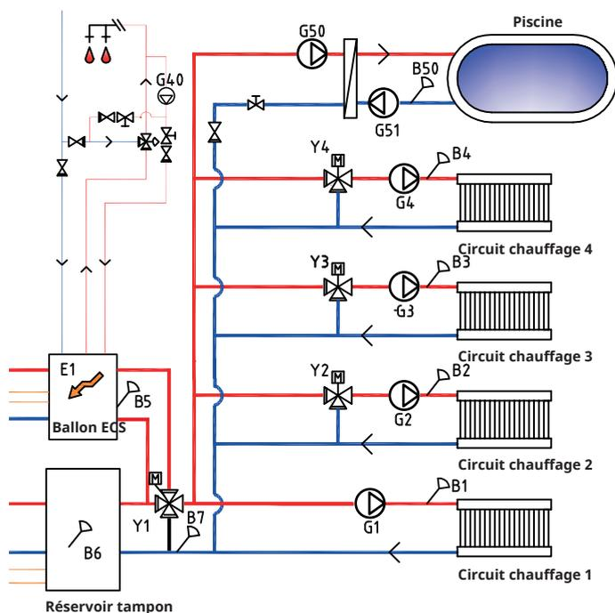
La CTC EcoPart i600M peut être reliée à quatre circuits de chauffage\*, chacun étant muni de sondes d'ambiance séparées. Les circuits de chauffage 2, 3 et 4 sont connectés par l'intermédiaire de vannes mélangeuses (Y2, Y3 et Y4).
