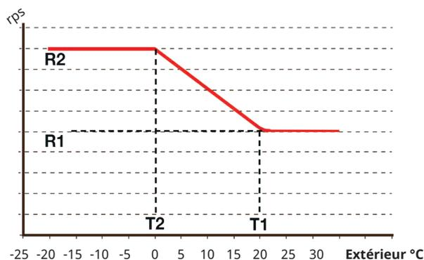
Le diagramme montre que la vitesse du compresseur est contrôlée en fonction de la température extérieure. Lorsque la température extérieure est inférieure à T2, la vitesse du compresseur s'ajuste jusqu'à R2. Lorsque la température extérieure dépasse T1, la vitesse du compresseur s'ajuste jusqu'à R1.
