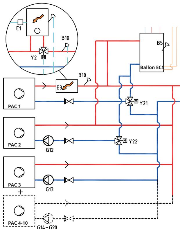
Jusqu'à 10 pompes à chaleur (PAC1 à PAC10) peuvent être montées ensemble avec leurs pompes de charge respectives (G11 à G20). La pompe de charge G11 est montée à l'usine dans PAC1 (CTC EcoPart i600M)
