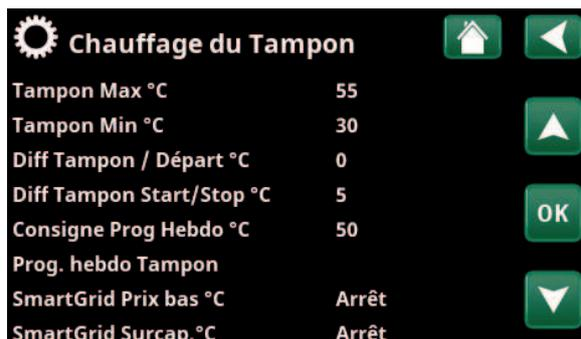
Menu : «Installateur/Réglages/Chauffage du Tampon»
