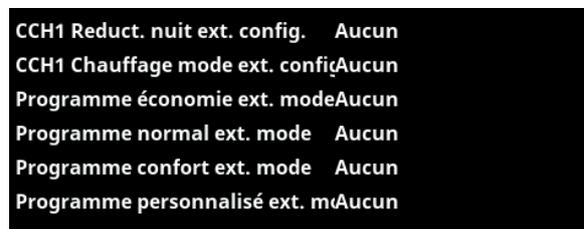
Menu « Installateur/Définir/Circ chauffage ». Dans les barres de menus « Programme économie / normal / confort / personnalisé ... », le mode normal est indiqué sur le signal de contrôle externe (« Normalement ouvert (NO) » ou « Normalement fermé (NF) »).
