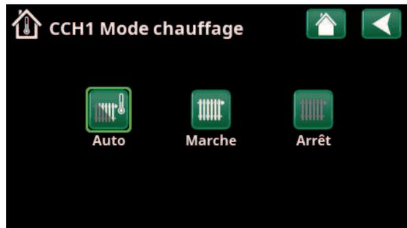
Menu « HC1 Chauffage/Refroidissement/HC1 Mode chauffage » où le mode « Auto » a été activé.
