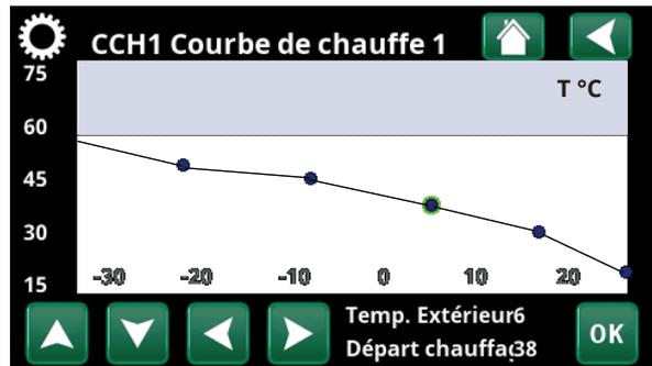
Menu « Chauffage/Refroidissement/HC1 Chauffage/Refroidissement ».
