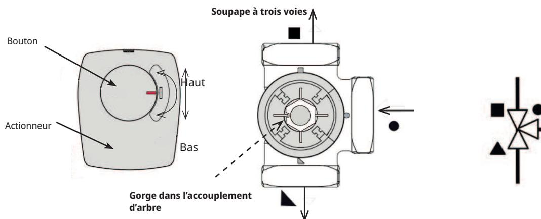
Le moteur de la vanne mélangeuse est monté sur la vanne avec le bouton dans la position centrale.
