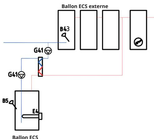
L'option B illustre la possibilité d'installer un ou plusieurs ballons ECS qui sont ensuite connectés via un échangeur de chaleur au ballon ECS inférieur illustré sur la figure. Cette solution nécessite l'installation d'une sonde de ballon ECS externe (B43) dans le réservoir tampon externe, ainsi que des pompes de circulation (G41) avant et après l'échangeur de chaleur.
