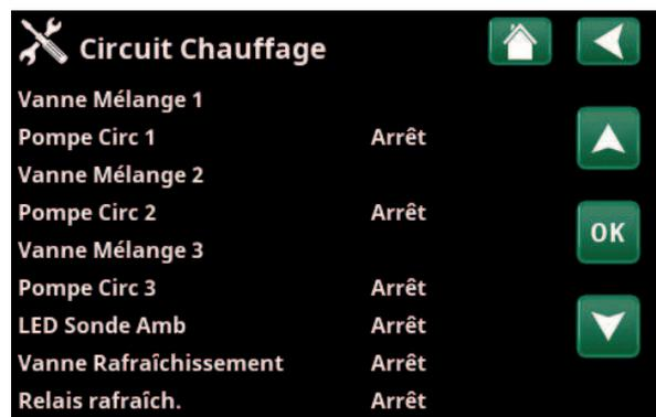
Menu : «Installateur/Service/Test Relais/Circuit Chauffage»
