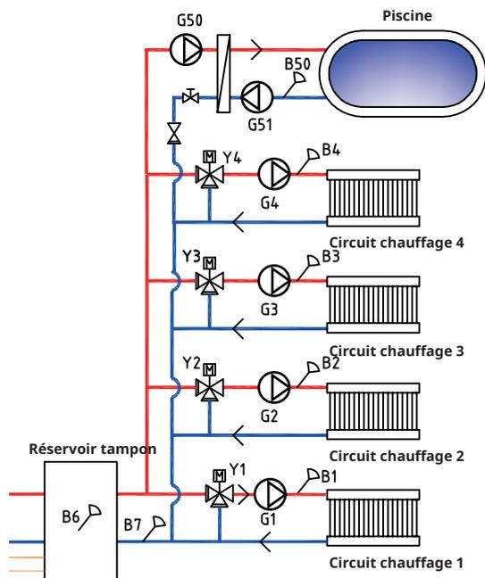
La CTC EcoPart i600M peut être reliée à quatre circuits de chauffage\*, chacun étant muni de sondes d'ambiance séparées. Les circuits de chauffage de 1 à 4 sont connectés par des vannes mélangeuses (Y1, Y2, Y3 et Y4).
