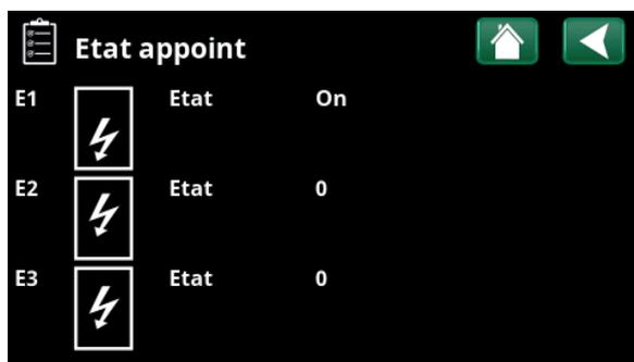
Pour afficher le menu, cliquez sur l'icône du chauffage d'appoint dans la liste des icônes en bas du menu État Installation/Démarrage. Cliquez sur un chauffage d'appoint (E1-E3) pour afficher les données de fonctionnement détaillées.
