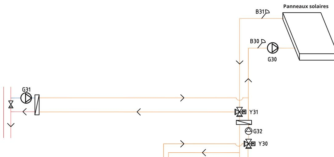
Depuis les panneaux solaires, le flux de chaleur est dirigé vers le ballon ECS/ réservoir tampon ou le serpentin de chauffage géothermique afin de recharger la roche/le sol une fois que le ballon ECS est complètement chargé.
