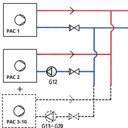
Jusqu'à 10 pompes à chaleur (PAC1 à PAC10) peuvent être montées ensemble avec leurs pompes de charge respectives (G11 à G20). La pompe de charge G11 est montée à l'usine dans PAC1 (CTC EcoPart i600M)
