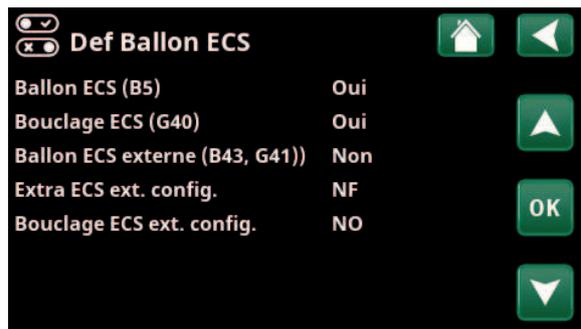
Menu : «Installateur/Définir/Ballon ECS» Dans la barre de menus «Extra ECS ext. config.», le mode normal est spécifié pour le signal de commande externe («Normalement ouvert (NO)» ou «Normalement fermé (NF)»).
