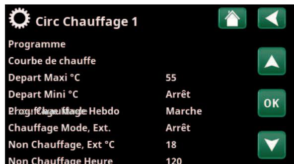
Menu : «Installateur/Réglages/Circ Chauffage/Circ Chauffage 1».
