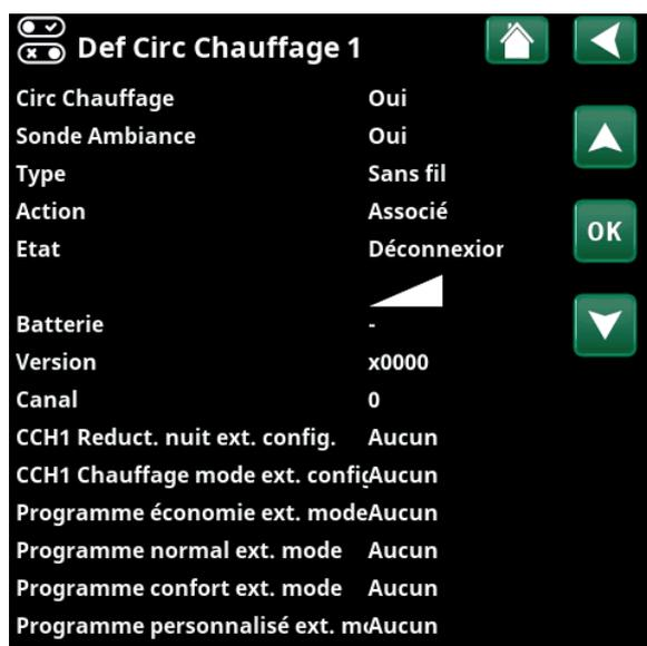
Menu : «Installateur/Définir/Circ Chauffage/Circ Chauffage 1».
