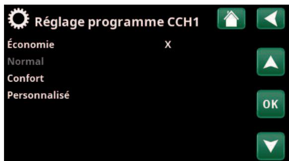
Menu « Installateur/Réglages/Circ Chauffage/Circ Chauffage 1/ Programme ».
