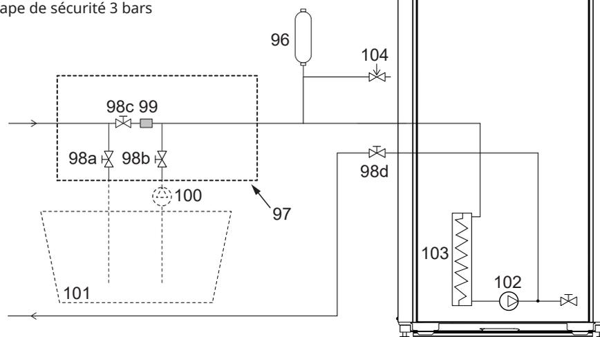
Le diagramme montre la connexion principale pour le circuit d'eau glycolée. L'équipement de remplissage est représenté par les sections en pointillés. N. B. : Les tuyaux du collecteur doivent comporter un dispositif de purge dans la mesure où des poches d'air peuvent se former. Vérifiez toujours le filtre (99) lors du remplissage et lors de la purge du circuit d'eau glycolée.
