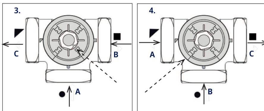
Le moteur de la vanne mélangeuse est monté sur la vanne avec le bouton dans la position centrale.
