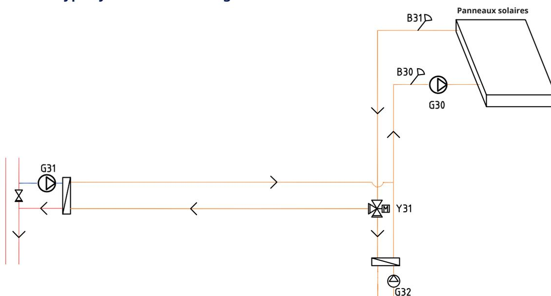
Des panneaux solaires peuvent être connectés à la chaudière à l'aide d'une vanne 3 voies (Y31) ou à un circuit de chauffage au sol pour recharger la roche/le sol.
