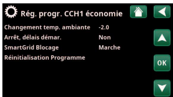
Menu « Installateur/Réglages/Circ Chauffage/Circ Chauffage 1/ Programme/Économie ».
