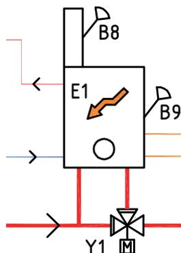
La chaudière existante est connectée au circuit de chauffage par l'intermédiaire d'une vanne mélangeuse (Y1).
