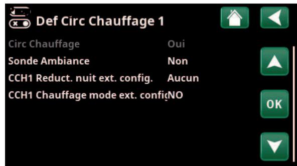
Menu : «Installateur/Définir/Circ Chauffage/Circ Chauffage 1».
