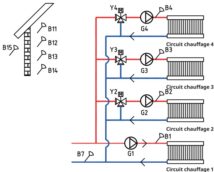
La CTC EcoPart i600M peut être reliée à quatre circuits de chauffage\*, chacun étant muni de sondes d'ambiance séparées. Les circuits de chauffage 2, 3 et 4 sont connectés par l'intermédiaire de vannes mélangeuses (Y2, Y3 et Y4). Si le chauffage d'appoint (E1) est défini, la vanne mélangeuse (Y2) doit être utilisée pour connecter un chauffage d'appoint au système (pas au circuit de chauffage 2).
