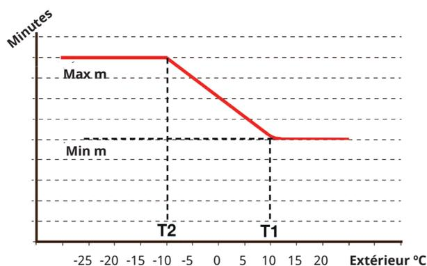
Le diagramme montre que le temps de chauffage du serpentin vers les bacs de condensation est régulé en fonction de la température extérieure.
