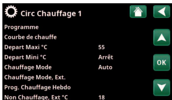
Menu : «Installateur/Réglages/Circ Chauffage». Le mode de contrôle à distance du circuit de chauffage est défini sur la barre de menus «Chauffage, Ext Mode». Accédez au programme hebdomadaire à partir de la barre de menus «Prog. Chauffage Hebdo».
