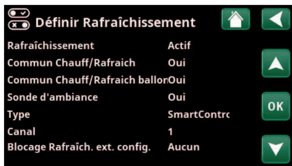
Menu : «Installateur/Définir/Rafraîch.» Dans la barre de menus «Bloc. Rafraîch ext. config.», le mode normal est spécifié pour le signal de commande externe («Normalement ouvert (NO)» ou «Normalement fermé (NF)»).
