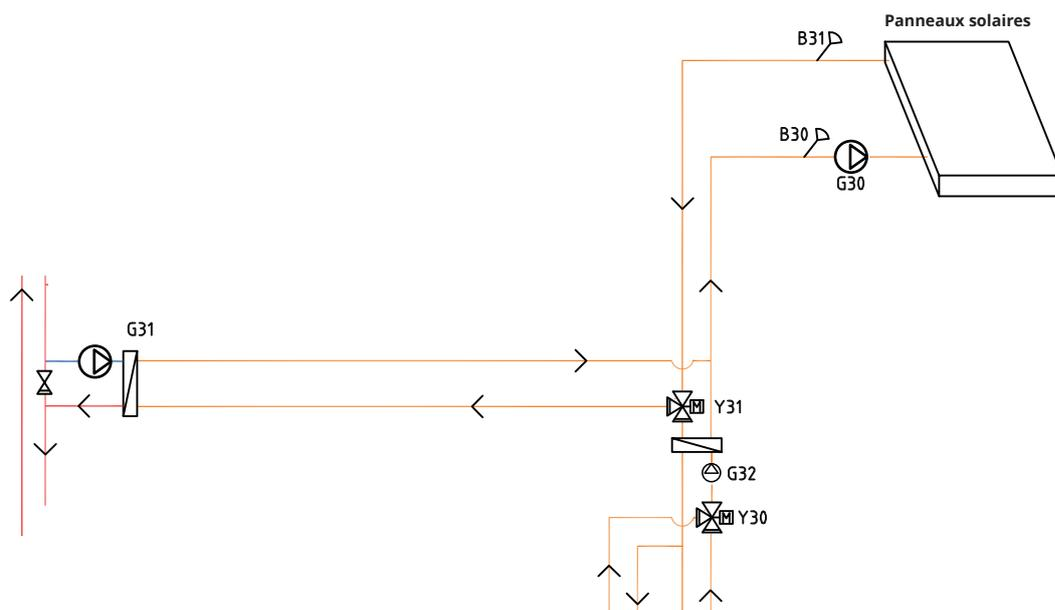
Depuis les panneaux solaires, le flux de chaleur est dirigé vers le ballon ECS/ réservoir tampon ou le serpentin de chauffage géothermique afin de recharger la roche/le sol une fois que le ballon ECS est complètement chargé.
