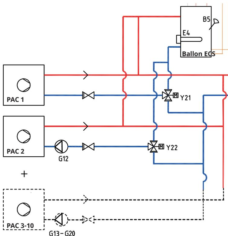
Jusqu'à 10 pompes à chaleur (PAC1 à PAC10) peuvent être montées ensemble avec leurs pompes de charge respectives (G11 à G20). La pompe de charge G11 est montée à l'usine dans PAC1 (CTC EcoPart i600M)
