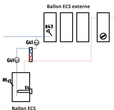
L'option B illustre la possibilité d'installer un ou des ballons ECS qui sont ensuite connectés via un échangeur de chaleur au ballon ECS inférieur illustré sur la figure. Cette solution nécessite l'installation d'une sonde de ballon ECS externe (B43) dans le réservoir tampon externe, ainsi que des pompes de circulation (G41) avant et après l'échangeur de chaleur.
