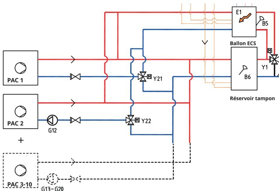
Jusqu'à 10 pompes à chaleur (PAC1 à PAC10) peuvent être montées ensemble avec leurs pompes de charge respectives (G11 à G20). La pompe de charge G11 est montée à l'usine dans PAC1 (CTC EcoPart i600M)
