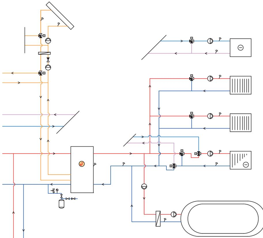
Système 4/5 - Le ballon de rafraîchissement manque dans le système.
