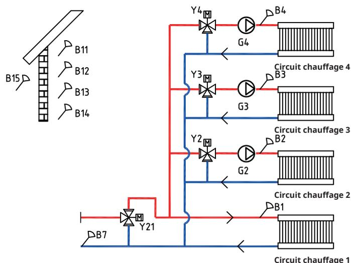
La CTC EcoPart i600M peut être reliée à quatre circuits de chauffage, chacun étant muni de sondes d'ambiance séparées. La soupape à trois voies (Y21) est la vanne principale et les vannes mélangeuses (Y2, Y3 et Y4) sont des vannes subsidiaires.
