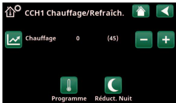
Menu « Installateur/Définir/Circ Chauffage/Circ Chauffage 1 ». Le circuit de chauffage ne comporte pas de sonde d'ambiance ; la valeur de consigne est affichée entre parenthèses (température de départ 45 °C). À gauche de la valeur de consigne est indiquée la température extérieure (0 °C) à la température de départ actuelle.
