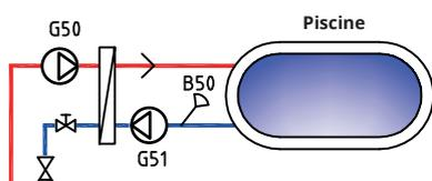
Via une sonde dans la piscine, la pompe de charge de la piscine démarre et s'arrête pour maintenir la température réglée dans la piscine (réglée en usine à 22 °C) et la température est autorisée à baisser de 1 °C avant que la pompe de charge ne redémarre. Il est également possible de régler la priorité de la piscine sur haute ou basse, ce qui détermine si le chauffage d'appoint peut être utilisé ou non pour chauffer la piscine. Voir le menu « Installateur / Réglages/Piscine ».
