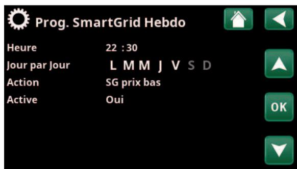
La fonction SmartGrid «SG Prix bas» est programmée en semaine de 22h30 à 06h00. Accédez au menu en sélectionnant «Prog. SmartGrid Hebdo» dans le menu «Installateur/Réglages».
