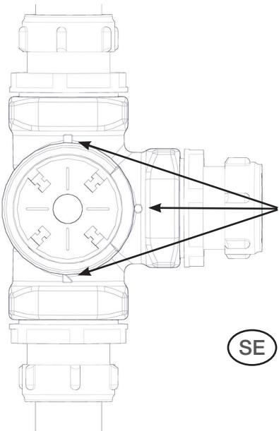
**OBS!** Anslut ■ mot övre tank, ▲ mot nedre tank och ● mot värmepumpen!
