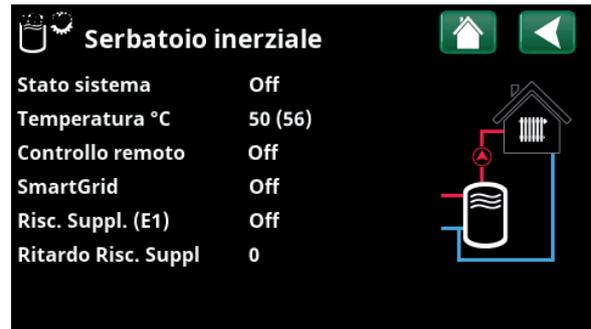
Menù "Dati funzionamento/Serbatoio inerziale esterno".
