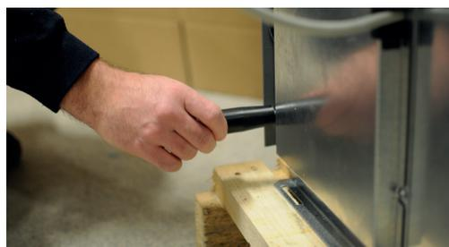
2. Collegare le due maniglie di trasporto alla parte inferiore del modulo.
