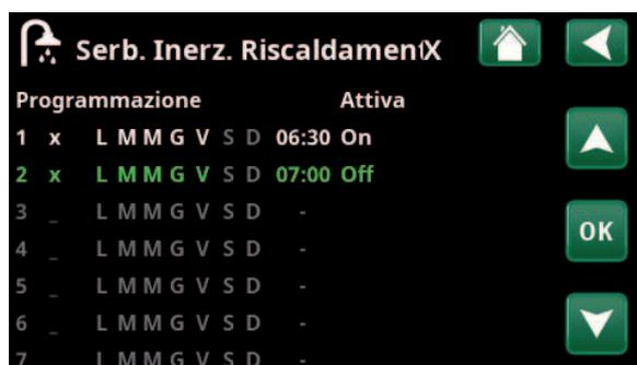
Nell'esempio, il riscaldamento del serbatoio di accumulo viene attivato ogni settimana, da lunedì a venerdì dalle 06:30 alle 07:00.
