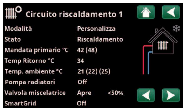
Il menù mostra i dati funzionamento dettagliati del circuito di riscaldamento selezionato. Fare clic sulle frecce o scorrere lateralmente per visualizzare circuiti di riscaldamento definiti.
