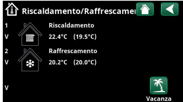
Fare clic sul circuito di riscaldamento 1 o 2 per passare al relativo menu. In questo menu è possibile attivare la "Modalità Vacanza" per i circuiti di riscaldamento.
