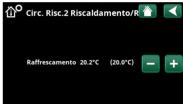
Nel menu, "Raffrescamento" (setpoint: 20,0 °C) è attivo per il circuito di riscaldamento 2. "Modalità Vacanza" (V) non diminuisce il setpoint quando è attivo il raffrescamento.
