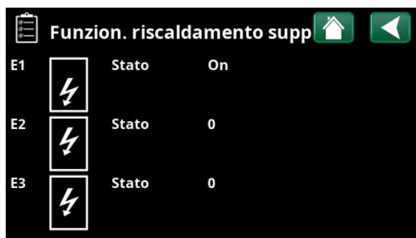
Il menù viene visualizzato se si fa clic sull'icona del riscaldamento supplementare nell'elenco delle icone nella parte inferiore del menù Dati funzionamento/Start menù. Fare clic su riscaldamento supplementare (E1-E3) per visualizzare i dati funzionamento dettagliati.
