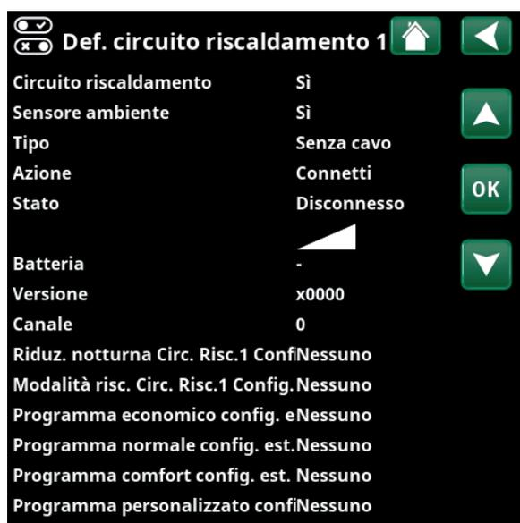
Menù: "Installatore/Definire/Circuito riscaldamento/ Circuito riscaldamento 1". Sensore ambientale senza cavo selezionato.
