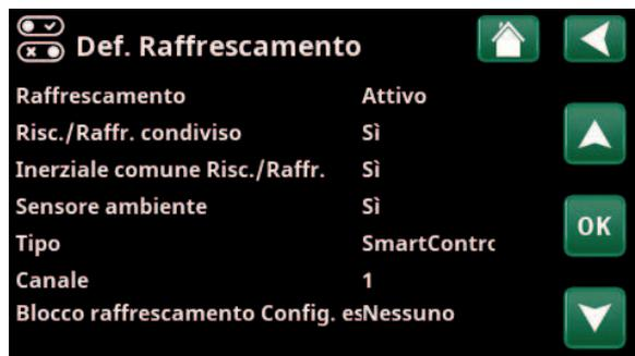
Sulla barra del menù "Blocco raffrescamento Config. est.", è specificata la modalità normale per il segnale di controllo esterno ("Normalmente aperto (NO)/Normalmente chiuso (NC)").
