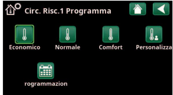
Menu "Circ. Risc. 1 Riscaldamento/Raffrescamento / Circ. Risc. 1 Programma" per il quale è stato attivato il programma "Economico".
