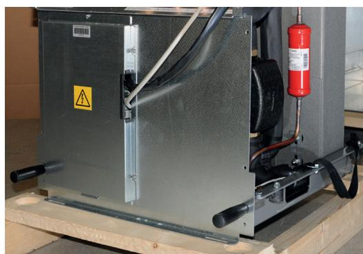
6. Inserire il modulo di raffreddamento nel prodotto utilizzando le maniglie di trasporto e gli spillacci. Rimuovere le maniglie di trasporto e ricollegare il cavo di alimentazione, i tubi e le viti.
