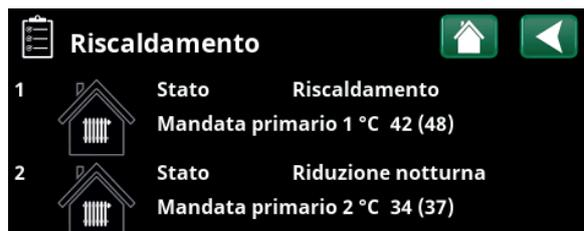
Menù "Dati funzionamento, Circuito riscaldamento". Il menù mostra le temperature attuali e lo stato dei circuiti di riscaldamento definiti.
