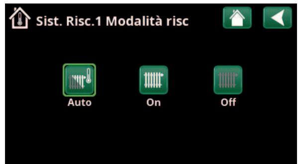
Menu "Circ. Risc. 1 Riscaldamento/Raffrescamento/Circ. Risc. 1 Modalità riscaldamento" per il quale è stato attivato il modo "Auto".
