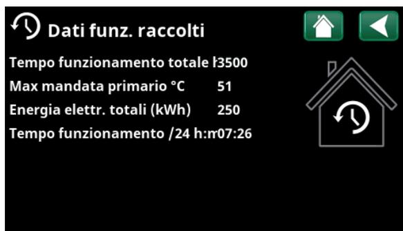
Menù: "Dati funzionamento/Stored dati funzionamento".
