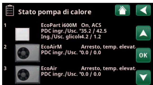
Il menù mostra lo stato e le temperature di funzionamento delle pompe di calore definite.
