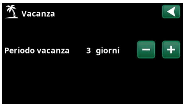
Quando la funzione "Vacanza" è attivata, la produzione di acqua calda viene interrotta. Si arresta anche la funzione "ACS extra temporanea".
