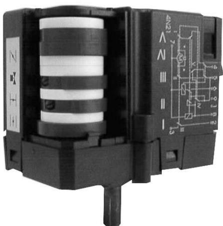
Der Stellantrieb STA dient zur Luftmengeneinstellung bzw. Magnetventilschaltung an zweistufigen Brennern mit Luftabschluss. Die Einstellung erfolgt über Endschalternocken auf der Stellantriebsswalze.
